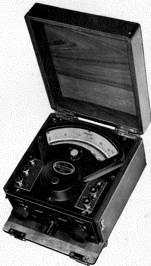
Fig. 5. Pyromètre portable spécial pour contrôle d'installations pyrométriques « à résistances ».
