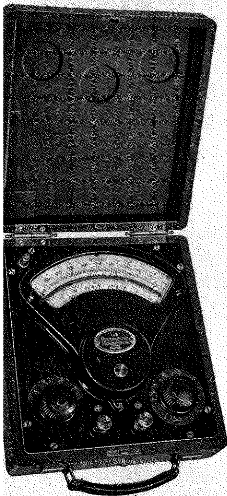
Fig. 4. pyromètre portable à rhéostat réglable type CR.
