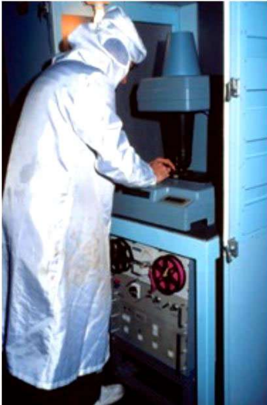
Illustration n° 2 : la Gyrex en chambre noire, avec son lecteur de ruban en bas. L'opérateur est vraisemblablement Maurice Lobet, du laboratoire de microélectronique de l'université de Louvain.
