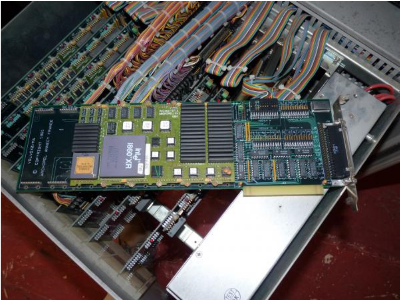
Photo : une des cartes supportant les micro-processeurs travaillant en parallèle (photos ACONIT)
