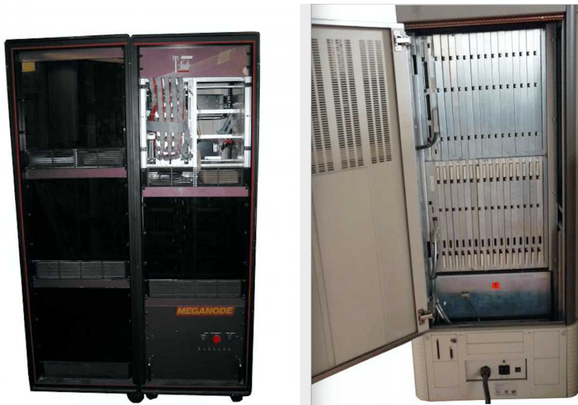
Evolution de la configuration des ordinateurs parallèles (photos ACONIT) Photo de gauche : Face avant du MégaNode - Photo de droite : Face arrière du MPP12000
