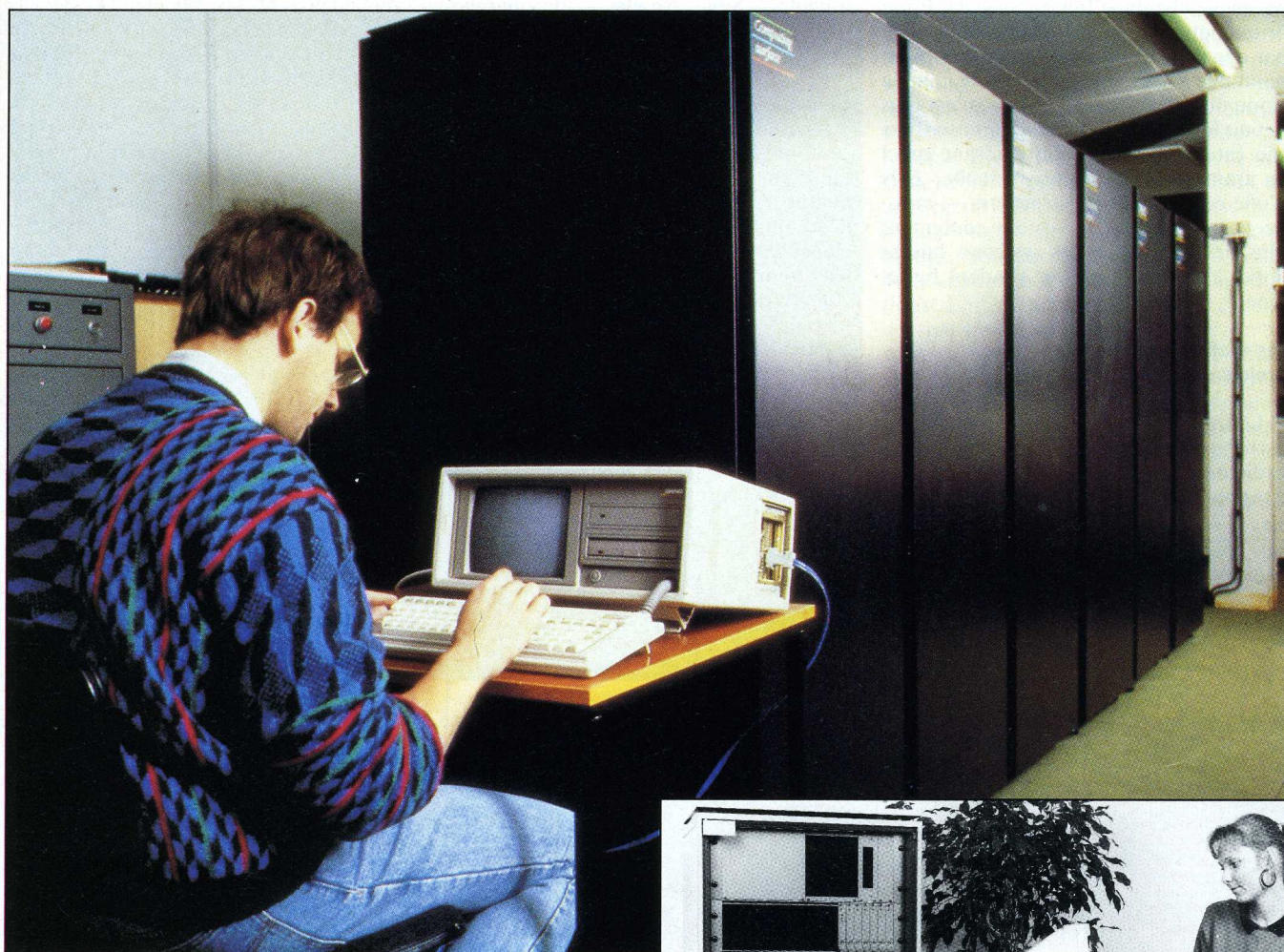
Figure 5. La société britannique Meiko a été l'une des premières à bâtir une machine, connue sous le nom de Computing Surface, faisant appel aux transputers (A). Elle a surtout été la première à commercialiser des modules (abritant en général chacun quatre transputers) qui peuvent être interconnectés entre eux, permettant ainsi la construction de machines parallèles modulaires. La société allemande Parsytec a repris la même idée pour l'architecture de son Megaframe Supercluster (B). Il comprend, dans sa version de base, 64 transputers. Des modèles plus puissants, affirme le constructeur, peuvent être obtenus en ajoutant des blocs supplémentaires de 64 transputers, sans limitation... (Clichés A, Meiko ; B, Parsytec)
