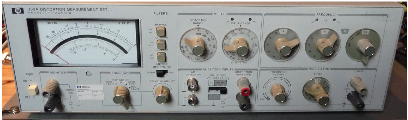
Die Front des HP 339A. Eine grosse Spiegelskala, eindeutige und ergonomisch gestaltete Schalter und Knöpfe - da macht das Bedienen Freude!
