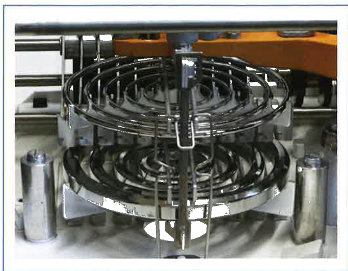
Figure 9 - Jeu de poids en anneaux d'une balance H54AR. En bas, 4 poids de 10 g, 20 g, 40 g et 80 g. En haut, 5 poids de 1 g, 2 g, 3 g, 6 g et 10 g. Collection UNIL/EPFL, Inv. 603.1037.
