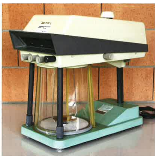
Figure 12 - Balance « semi-micro » S6 (capacité 80 g, sensibilité 5 µg), et aperçu de l'intérieur. L'affichage montre une combinaison de poids de 63,8 g actionnés par les 3 boutons rotatifs et une projection optique d'un déséquilibre de 09625 microgrammes. Collection UNIL/EPFL, Inv. 603.0422.
