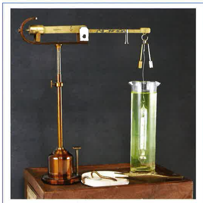
Figure 4 - Balance pour la mesure de la densité des liquides. G. Westphal, Celle, 1881. Collection UNIL/EPFL, Inv. 603.0917.
