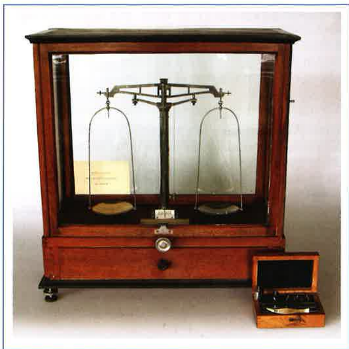
Figure 1 - Balance à deux plateaux avec son jeu de poids (début 20 ème s.). Collection UNIL/EPFL, Inv. 603.0154.
