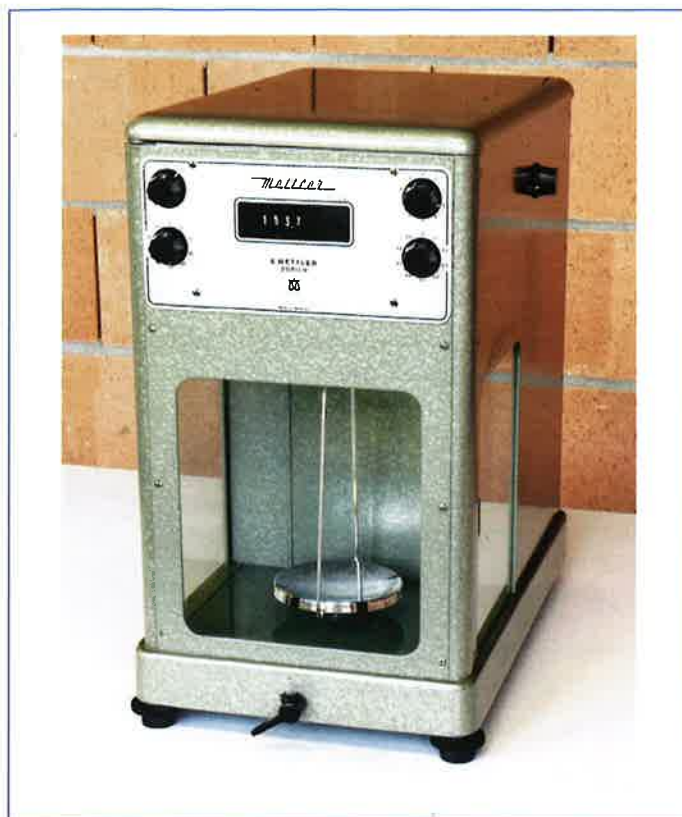
Figure 6 - Balance Mettler B5, dans son boîtier métallique vitré. 4 boutons rotatifs actionnent le jeu de poids interne : 0-100 g, puis 3 décades 0-90 g, 0-10 g et 0-1 g. Lecture optique des décimales suivantes. Collection UNIL/EPFL, Inv. 603.0740.
