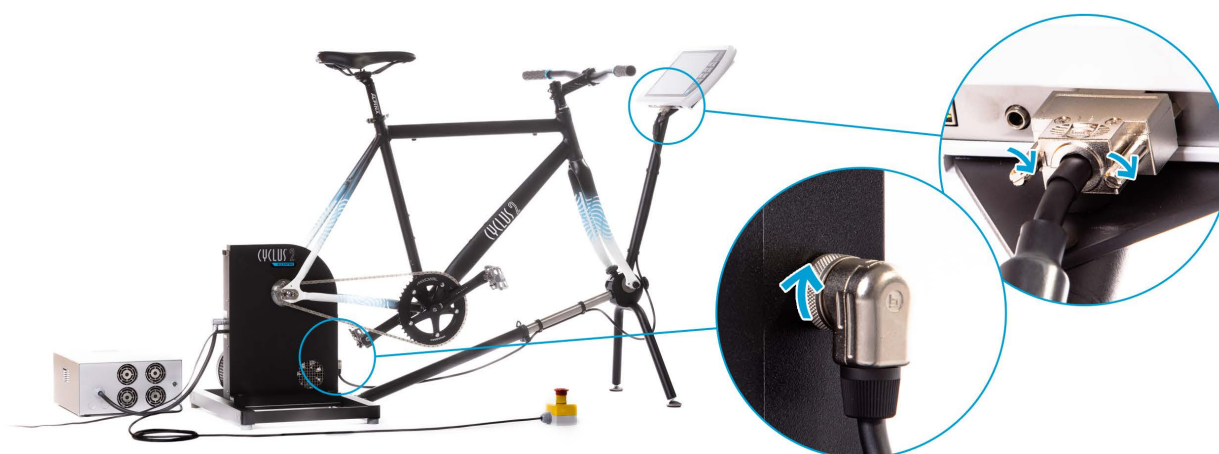
Figure 8 : Raccorder le câble de liaison appareil de commande/groupe de freinage
