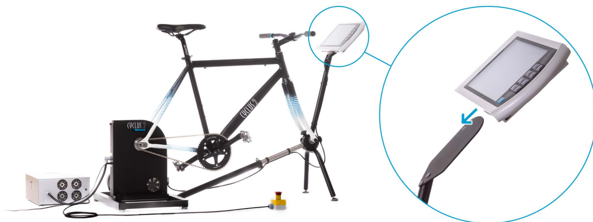
Figure 7 : Faire coulisser l'appareil de commande sur la languette du support
