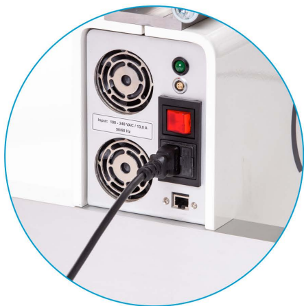
Figure 26 : Raccordement au réseau électrique
