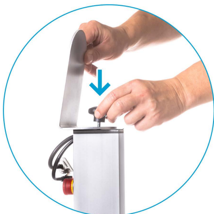
Figure 21 : Fixation du tiroir comme logement pour le pupitre de commande
