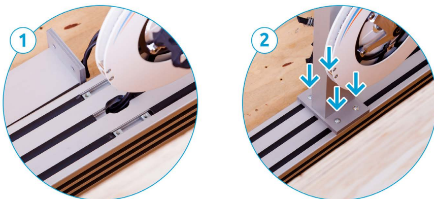
Figure 16 : Montage du support sur le cadre
