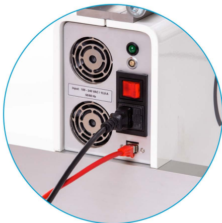
Figure 24 : Connexion du câble réseau
