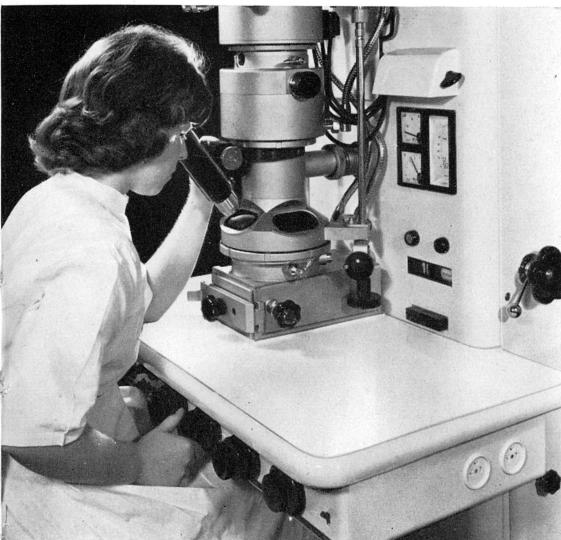
Bild 14 Zum genauen Beobachten kann eine Fernrohrlupe vor das Bild geschwenkt werden. Die wesentlichen elektrischen Bedienungselemente liegen griffgerecht in der Tischzarge
