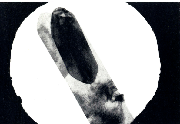
Bild 42 Durchstrahlungsaufnahme der Kristalle, deren Beugungsdiagramm Bild 41 zeigt Elektronenoptische Vergrößerung 21 000 : 1 Gesamtvergrößerung 31 500 : 1; Strahlspannung 80 kV
