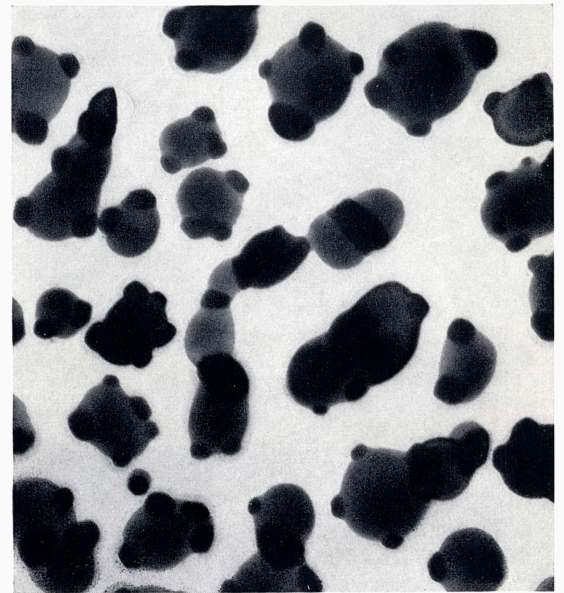
Bild 39 Durchstrahlungsaufnahme Objekt: Thalliumchlorid Elektronenoptische Vergrößerung 40 000 : 1 Gesamtvergrößerung 100 000 : 1 Strahlspannung 80 kV
