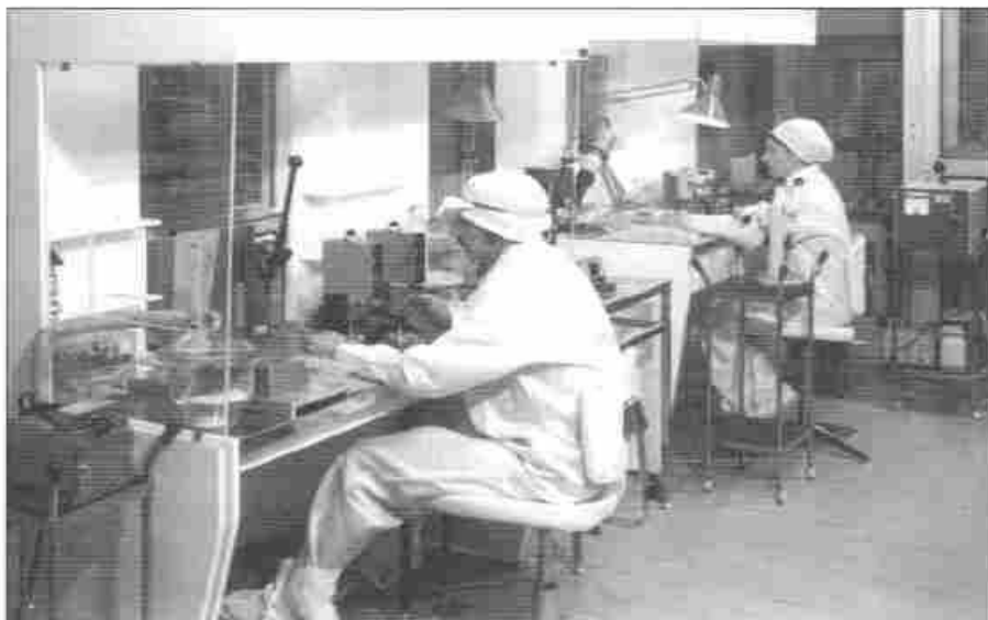
Toute poussière pouvant être néfaste au fonctionnement d'un tube, et particulièrement d'un tube spatial, l'assemblage final des top est effectué dans une salle blanche
