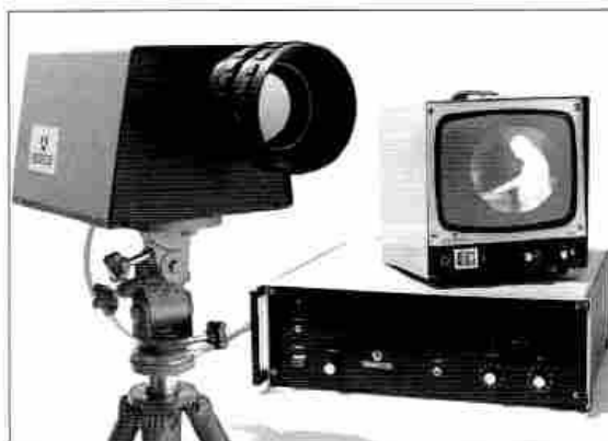
Caméra infrarouge TTE à pyricon
