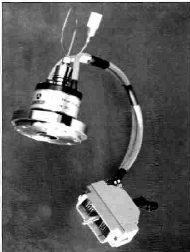
Détecteur DTE pour imagerie infra rouge 10 \mu m THX 702
