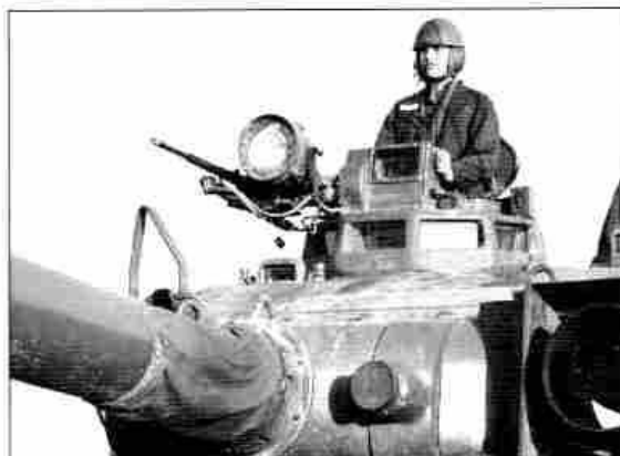
Caméra de tir montée sur char AMX 30 utilisant un SuperNocticon
