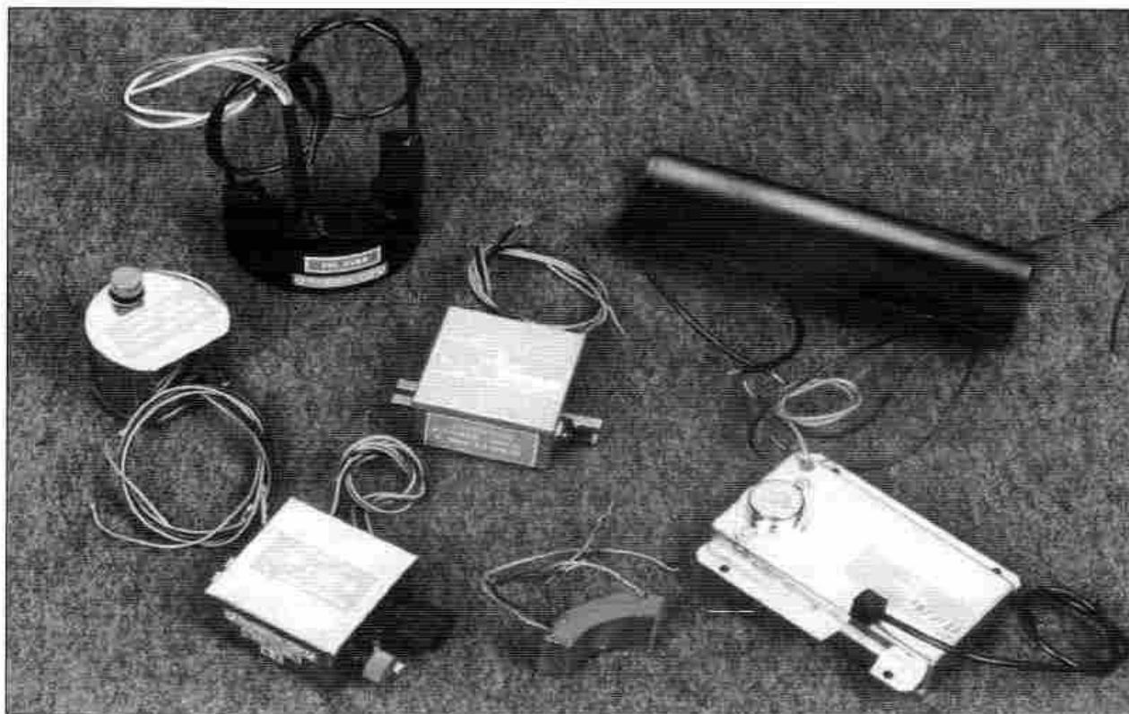
Alimentations Hautes tensions pour différents tubes intensificateurs (1972/1980)
