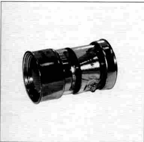
Le tube convertisseur infrarouge D 16 (JEDEC 6914)
