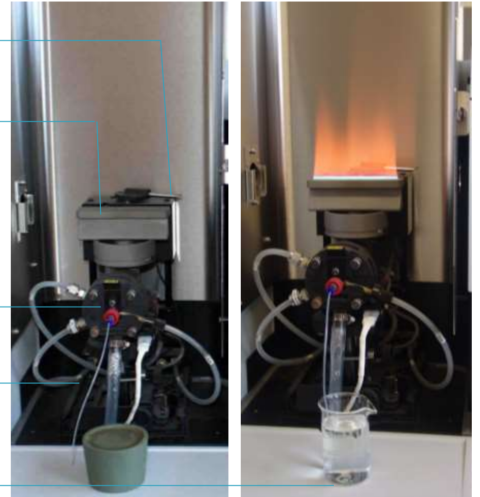
Figure n°5 a et b : bruleur à l'arrêt et en marche
