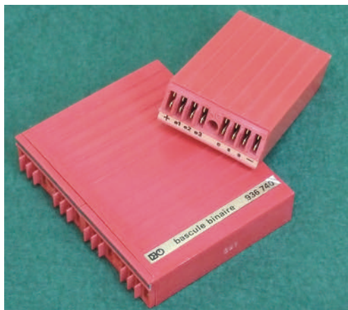
Boîtiers de CUSA en électronique conventionnelle, dans la série SILIMOG de MERLIN-GERIN.
