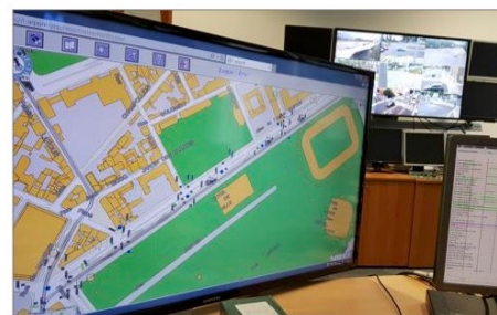
Parmi les écrans du PC "feux tricolores", celui-ci permet de voir la couleur desdits feux en temps réel (ici, boulevard Jean-Pain à Grenoble). Photo Le DL/V.P.
