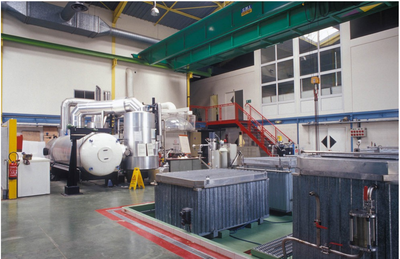
2005 : vue générale sur le hall de traitement avec, au premier plan, les cuves d'immersion au polyéthylène-glycol des objets archéologiques de moyenne dimension avec filtration et chauffage.
