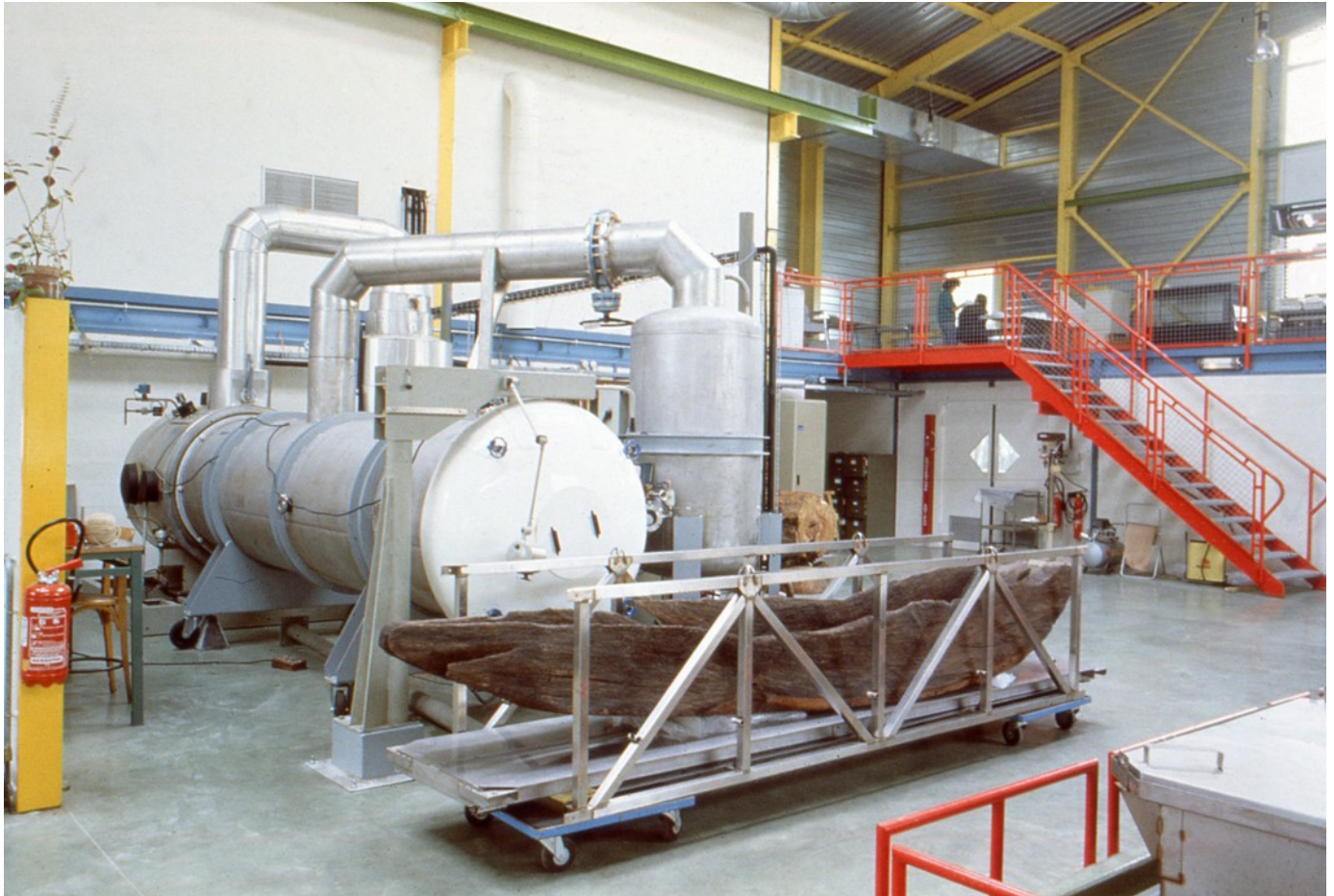
1989 : la pirogue de Charavines-Colletière, première embarcation à avoir été asséchée par l'Atelier dans une nouvelle configuration de 5 m de long de l'enceinte, après ajout d'une extension de 4 m avec isolation à double parois et vide partiel ; porte initiale réutilisée et second piège adjoint à la virole.
