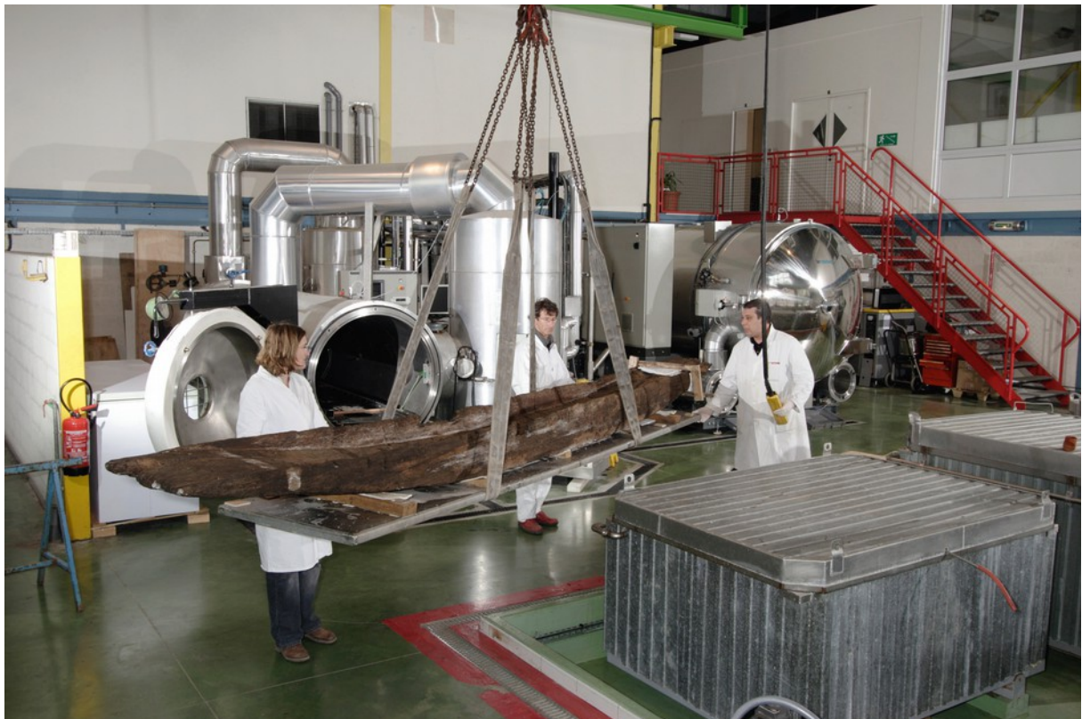
2008 : la même pirogue sortie du lyophilisateur à l'aide du pont roulant ; on aperçoit au fond le second gros lyophilisateur Telstar qui vient d'être installé à côté du lyophilisateur historique.
