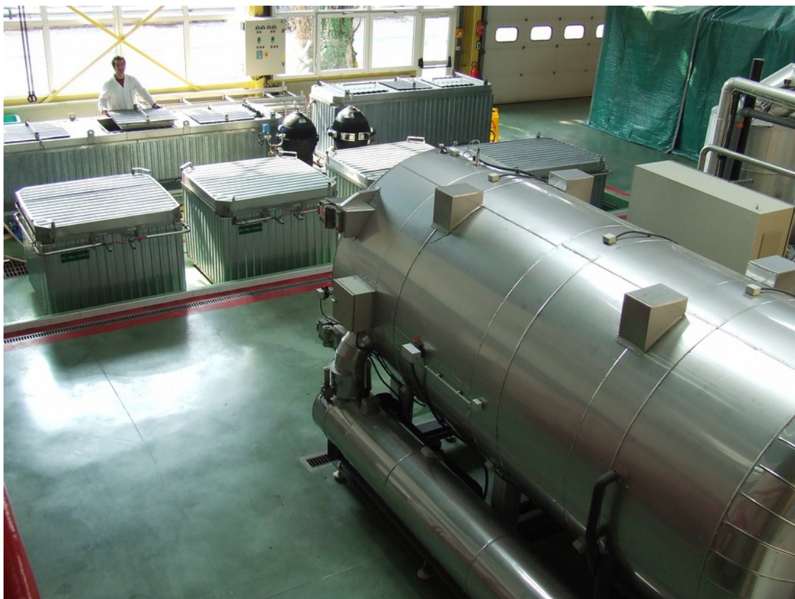
Le lyophilisateur fTelstar aisant face aux cuves d'imprégnation au PEG avec, au fond, la cuve longitudinale destinée aux embarcations de type pirogue.
