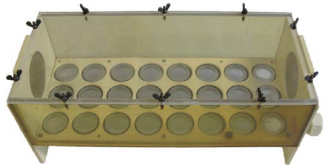
La cage à population comprend 24 godets. Elle mesure 40 cm de long sur 20 cm de large.
