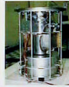
Le "Space ThermoAcoustic Refrigerator" construit par l'équipe de S.L. Garrett est embarqué dans la navette spatiale Discovery
