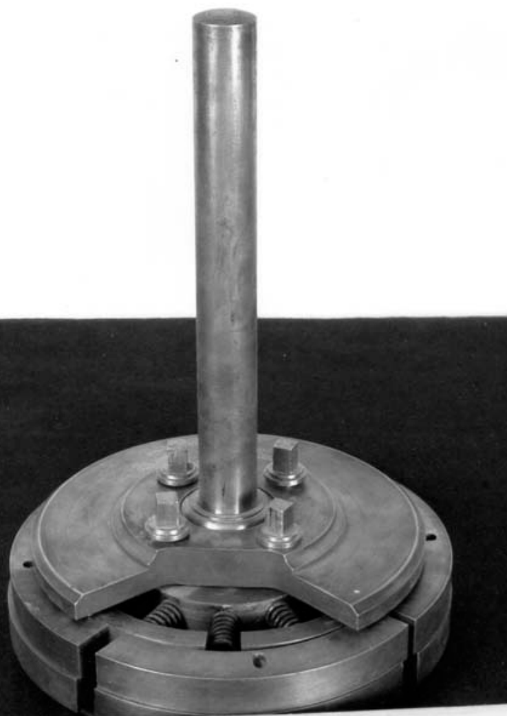
PISTONS DIFFÉRENTIELS, POUR MACHINES À HAUTES PRESSIONS
