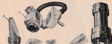
Bild 2. Prismen aus Eintauchrefraktometer 1 nichtheizbares Prisma, 2 heizbares Prisma, 3 Justierprisma, 4 Justierplättchen, 5 Hilfsprisma, 6 Becherglas
