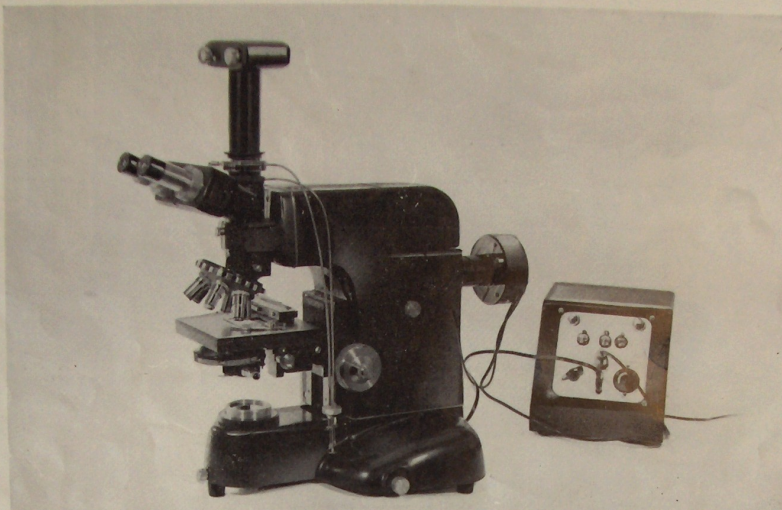
Microscope Universel U équipé en "Contraste Interférentiel", Brevet C.N.R.S. Nomarski, avec Flash Electronique
