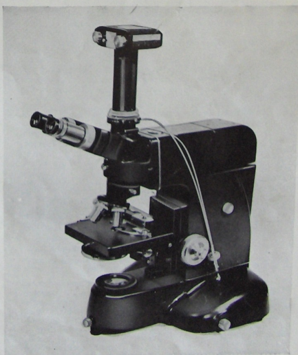
Microscope Universel U à contraste de phase
