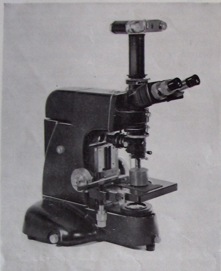
Microscope Universel U équipé du patin interférentiel
