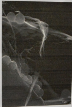
Mousse de nanotube de carbone avec billes de silice Image : Isabelle Ly
