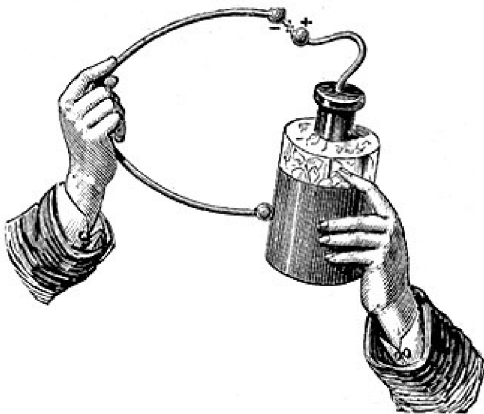
Fig. 224. – Moyen de décharger brusquement une bouteille de Leyde.
