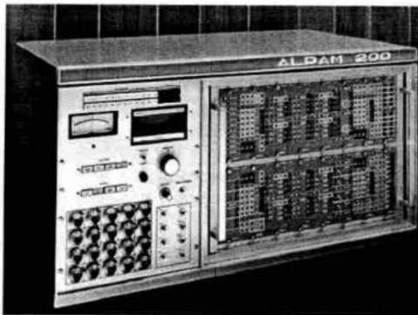
Un calculateur analogique ALPAM 200 (28 opérateurs, panneau de programmation débrochable)
