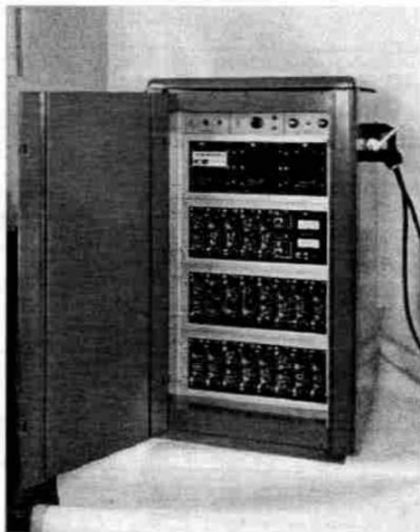
Le calculateur CARNAC ayant équipé l'usine de Wloclawek (Pologne), en vue de la conduite de 4 neutraliseurs produisant 2400 tonnes par jour de nitrate d'ammonium
