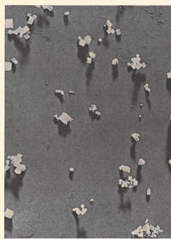
Fig. 17. Microgramme d'oxyde de magnésium, enregistré avec le microscope électronique Philips, avec un grossissement de 18 000 \times . Les cristaux cubiques se trouvent sur un film de "Furuvax" et le tout est "ombré" par un jet de vapeur d'uranium. En haut, sur le bord gauche de la photo, on voit deux traits, dont la distance indique la longueur de 1 \mu . La photo b donne un détail de a, agrandi 60 000 \times . L'examen plus précis des microgrammes originaux montre que le pouvoir séparateur est supérieur ici à 50 Angströms. Avec des exemplaires de fabrication industrielle du microscope décrit ici, des microgrammes furent déjà obtenus, sur lesquels, comme on peut le constater avec certitude, le pouvoir séparateur atteignit 25 Angströms.
