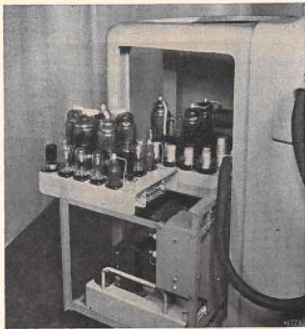
Fig. 22. Châssis sorti de sa boîte, avec les trois appareils d'alimentation de la lentille-condenseur (max. 100 mA), de la lentille de diffraction et de la lentille intermédiaire (max. 100 mA), et des lentilles objectif et projectif (max. 400 mA). Le dernier appareil d'alimentation cité, contient, à cause de la grande intensité de courant requise, trois pentodes EL 51 en parallèle, à la place de la pentode B_1 . A l'arrière l'appareil à tension d'alimentation stabilisée fournissant la tension constante de comparaison E_0 .
