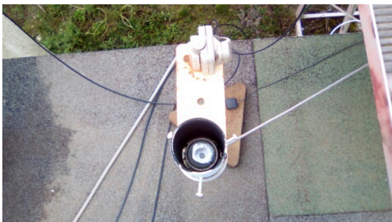
Photo 3. Tête optique à l'avant et antenne GPS à l'arrière installés sur le toit de la SGM à l'OHP.
