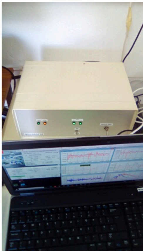
Photo 2. Instrument Mini-SAOZ #5 à l'arrière et son ordinateur à l'avant qui gère l'instrument.
