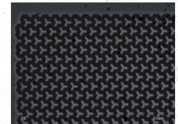
Vue de dessus des structures en tripod faites dans le Silicium, réalisées avec un MEB- 2019 – échelle : la largeur d'un tripod est de l'ordre de 2µm
